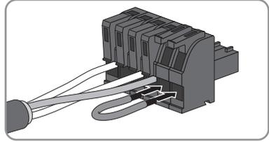
8. Den 6-poligen Stecker in die Buchse X2 des Produkts stecken.
