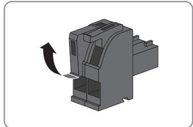
4. Das Anschlusskabel an den mitgelieferten 2-poligen Stecker anschließen. Dazu die Adern in die Leitereinführungen stecken und die Leitereinführungen verriegeln. Dabei die Belegung des Steckers beachten.
