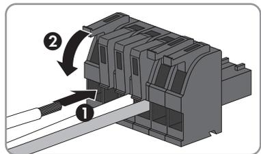
7. Wenn sich das Produkt am Ende des RS485-Busses befindet, eine Drahtbrücke als Leitungsabschluss zwischen Pin 5 und Pin 6 des 6-poligen Steckers setzen.
