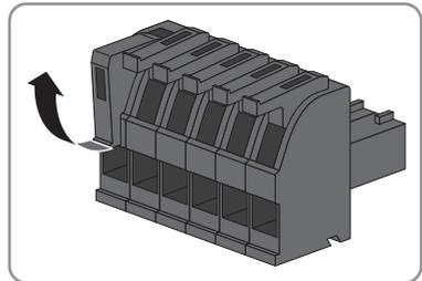
6. Die Leiter des RS485-Kommunikationskabels an den mitgelieferten 6-poligen Stecker anschließen. Dazu die Adern in die Leitereinführungen stecken und die Leitereinführungen verriegeln. Dabei die Belegung des Steckers beachten.
