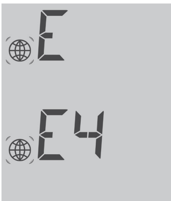
Abb.: Beispiel Blinkcodes für Internet - Fehler 4
