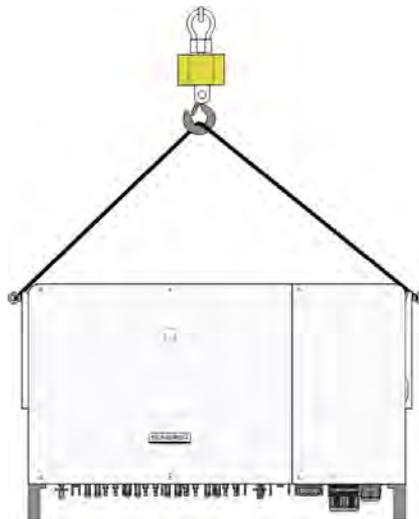
**Passaggio 4** Rimuovere gli anelli di sollevamento e rimontare le viti sigillanti rilasciate al passaggio 1.
