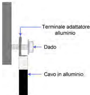
Figura 5-3 Sequenza di collegamento del terminale del cavo in alluminio
