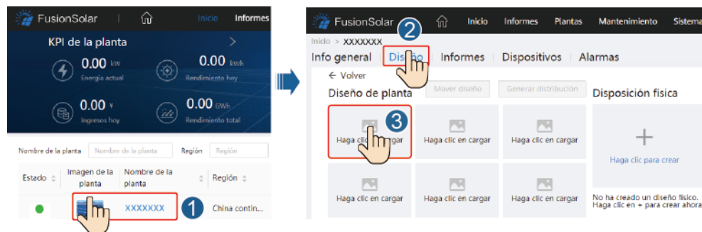
Figura 7-5 Carga de una foto de plantilla de diseño físico (interfaz de usuario web)
