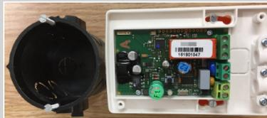
4. Die drei Schrauben an der Unterseite des Gerätes lösen und den Kabelhalter entfernen.
