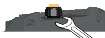
Fig. 6-15: Apretar el racor para cables por la parte posterior
