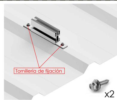
El perfil se fija a la chapa mediante 2 tornillos autorroscantes.
