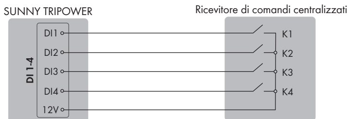
Figura 11: Collegamento di un ricevitore di comandi centralizzati - ingresso digitale DI 1-4
