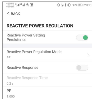
Figura 7-17 Regulación de potencia reactiva
